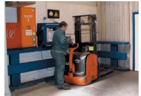
Bild 4-4: Einzelladeplatz für ein Mitgänger- Flurförderzeug
