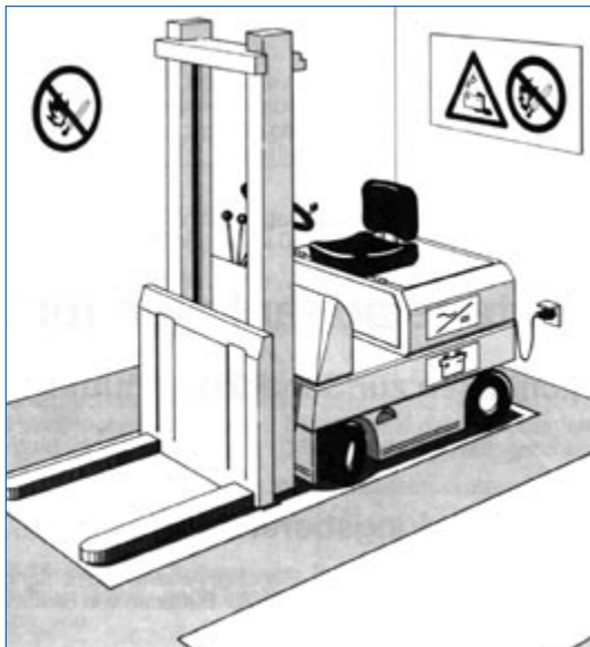
Bild 4-5: Ladestelle für einen Gabelstapler mit bordeigenem Ladegerät
