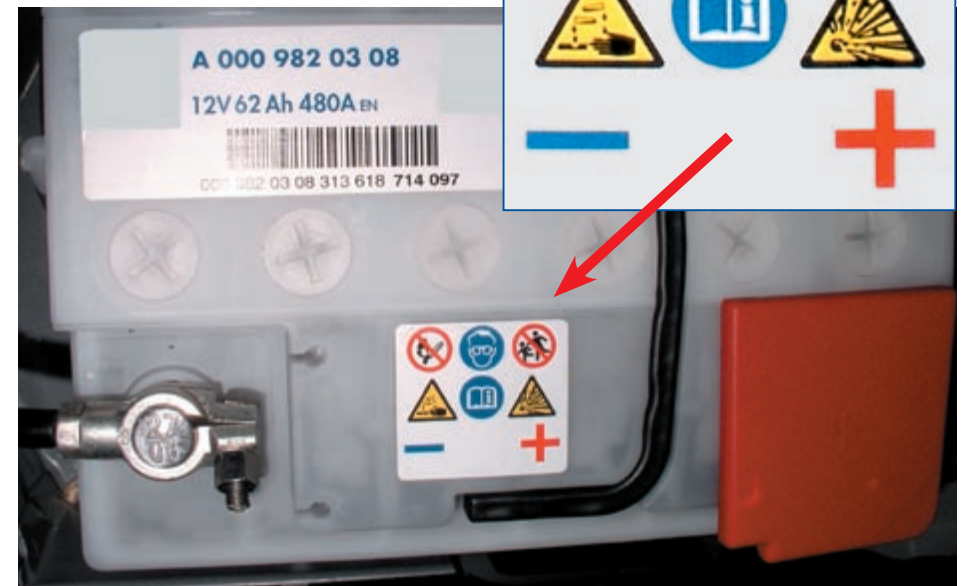
Bild 4-2: Werkseitige Sicherheitskennzeichnungen eines Herstellers von Kfz-Batterien, für Fachleute und Laien
