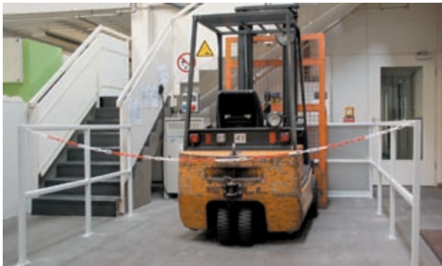
Bild 4-3: Abgegrenzter Einzel- ladeplatz innerhalb einer Werkhalle für ein Flurförder- zeug mit Hubeinrichtung
